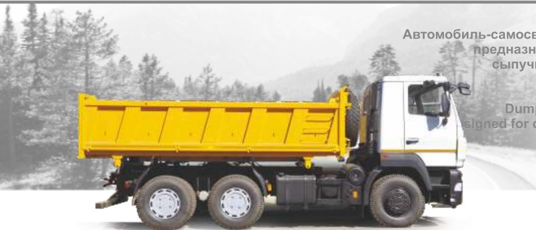
Автомобиль-самосвал с трехсторонней разгрузкой предназначен для перевозки различных сыпучих грузов в составе автопоезда
