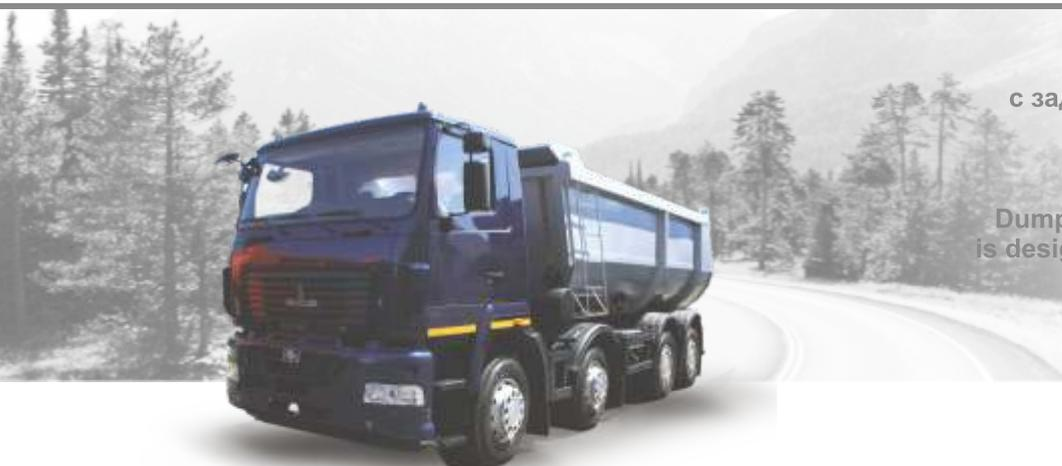
Автомобиль-самосвал с задней разгрузкой, предназначен для перевозки различных сыпучих грузов
